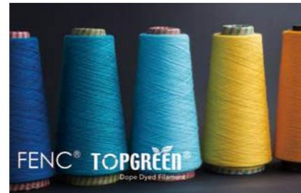
在抽絲過程加入色粒製成纖維，減少後段染整過程中的化學染料助劑使用、廢水處理、有毒物質產生等等，可大幅節省用水、能源耗損及 CO<sub>2</sub> 排放量，是新一代環保節能纖維，更提供較佳的耐日光色牢度、耐水洗色牢度。
